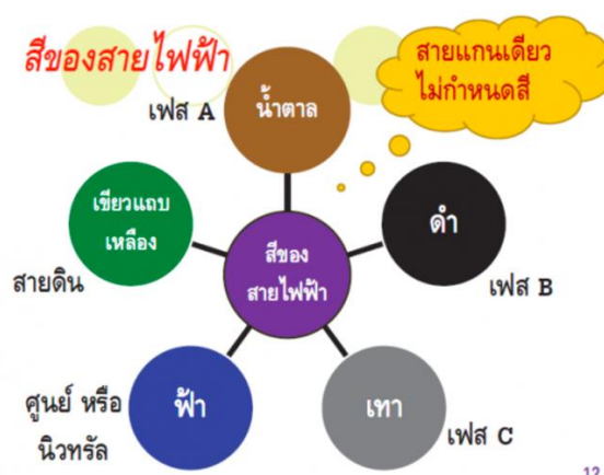
ภาพที่ 10 สีของฉนวนหุ้มสายไฟฟ้า
